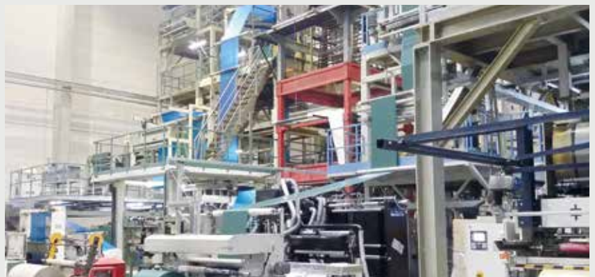
Hochwertige Folienblasanlagen dienen der Herstellung der extrem reiß- und dehnfähigen Folien
